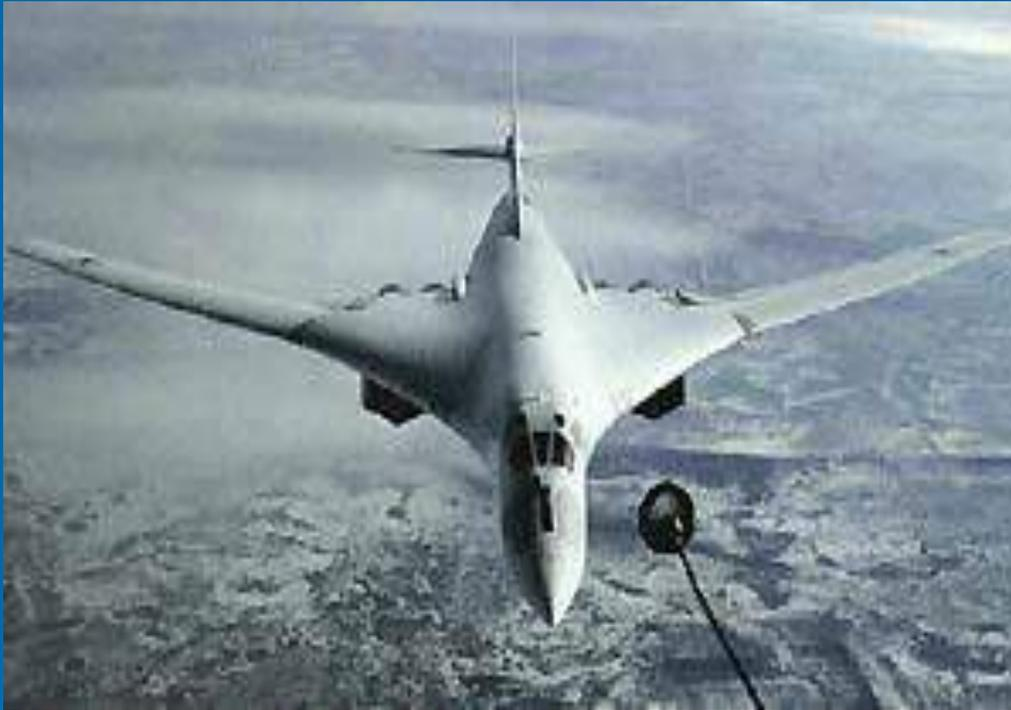
Бомбардировщик оснащен аналоговой электродистанционной системой управления с четырехканальным резервированием по каналам тангажа, крена и рыскания, обеспечивающей оптимальные характеристики устойчивости и управляемости на всех режимах полета. Реализован принцип «электронной устойчивости» с полетной центровкой, близкой к нейтральной.
