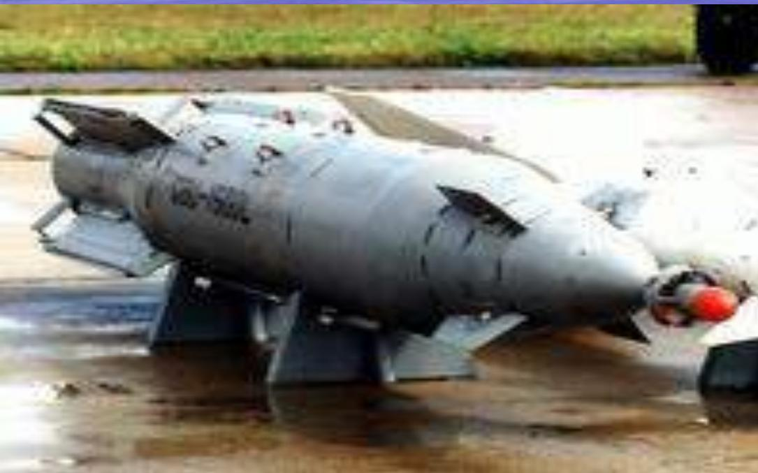
Корректируемые авиационные бомбы КАБ-1500 калибра 1500 кг предназначены для поражения наземных и надводных стационарных целей, в том числе особо прочных и заглубленных в землю объектов - фортификационных сооружений, командных пунктов, входов в туннели, ВПП, мостов, плотин и т.п. В зависимости от модификации бомбы оснащаются одной из двух систем наведения - полуактивной лазерной (КАБ-1500Л) или телевизионно-командной (КАБ-1500ТК). Боевая часть бомбы - фугасная или проникающая.
