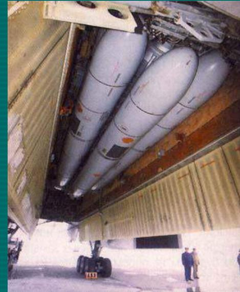
Стратегический вариант способен с высокой точностью поражать стационарные цели на удалении от точки пуска. Каждый бомбардировщик Ту-95МС может нести до шести ракет типа Х-55, расположенных на пусковой барабанной установке катапультного типа в грузоотсеке самолета. В двух грузоотсеках сверхзвукового Ту-160 может располагаться 12 крылатых ракет большой дальности (с дополнительными баками) или 24 обычных крылатых ракеты.
