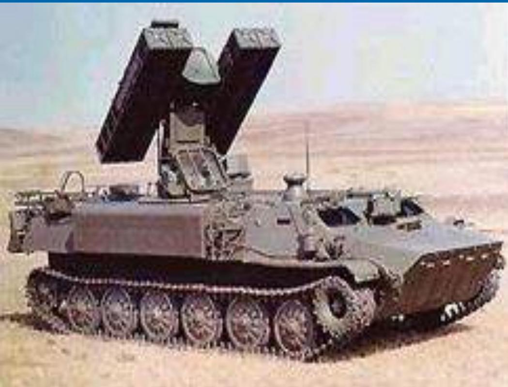
ЗРК "Гюрза" создан на базе зенитного ракетного комплекса "Стрела-10М".
